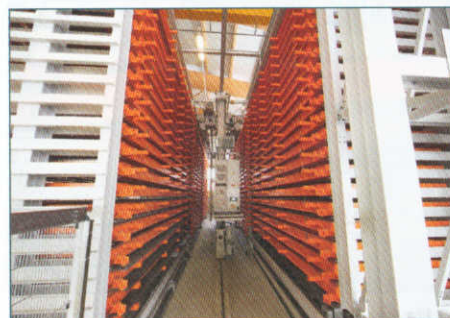
Blick in die Regalgasse eines Uniline-Lagersystems mit Regalbediengerät und Regalblock.
