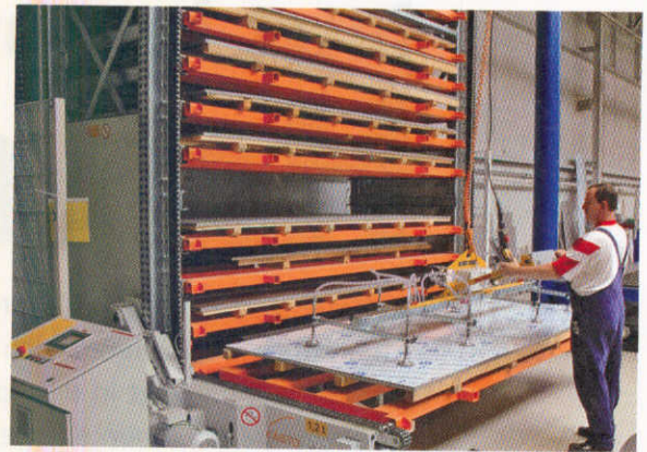
Für kurze Handlingwege steht das Blechlager bei Hobart neben der Flachbett-Laserschneidanlage.
