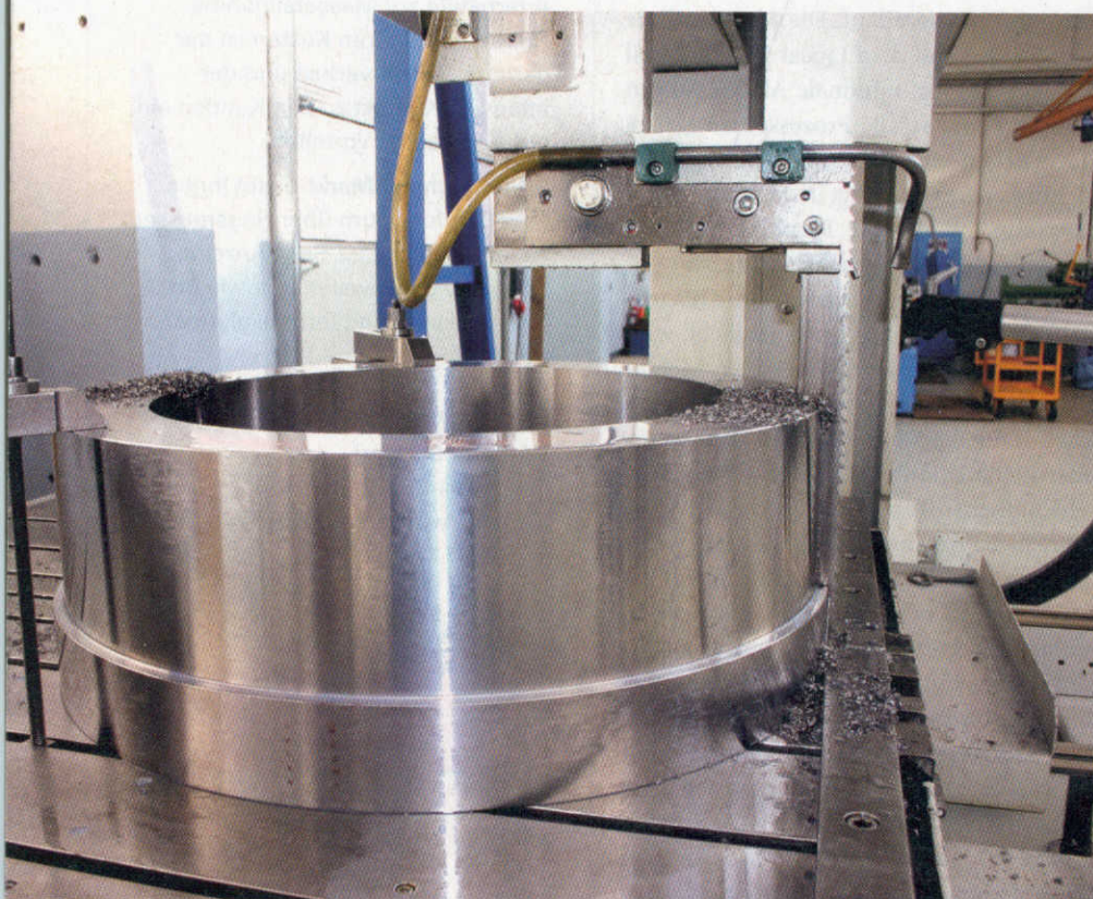
Bild 1: Auf einer Vertikal-Sägemaschine wird ein massiv fertiggedrehter und mehrere 100 mm hoher Ring mit einer Genauigkeit von 0,1 mm gesägt.
