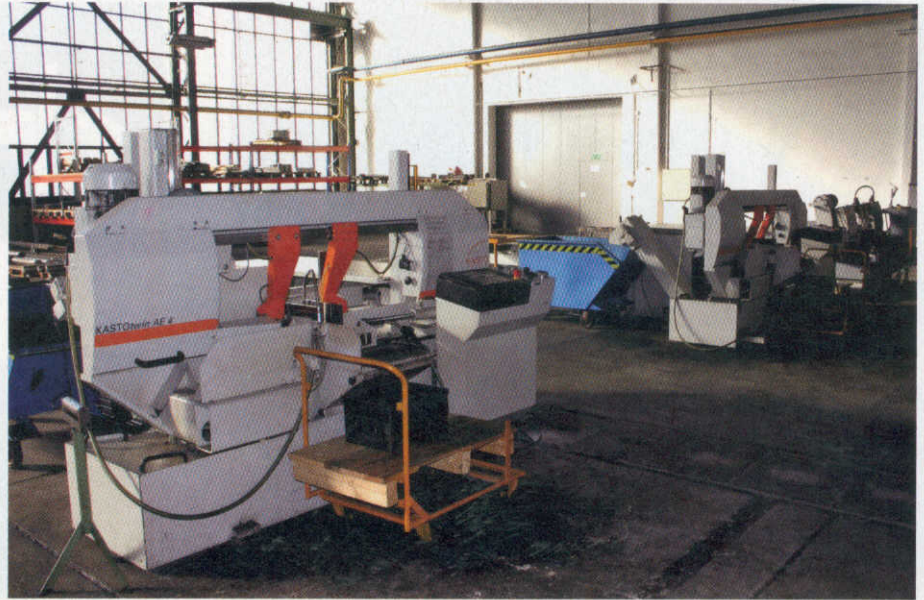
Bild 2: Drei Bandsägemaschinen sorgen für eine reproduzierbar maßgenaue Rohteile-Herstellung für die Bereiche Turbinenschaufel- und Präzisionsteile-Fertigung.
