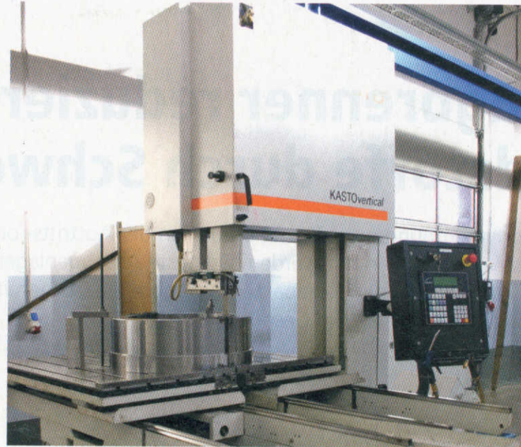
Bild 4: Die Block-, Platten- und Probe-schnittbandsäge ist mit einem verfahrbaren Maschinentisch, der bis zu 2000 kg Werkstückgewicht aufnimmt, ausgerüstet.
