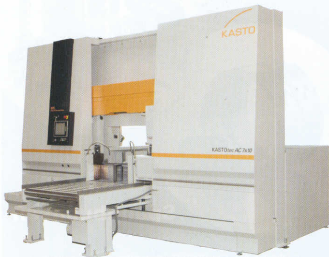
Zeigt die Abfahrseite der KASTOtec-A7x10 Bandsägemaschine mit einer EasyControl-Steuerung und dem um 90° gedreht angeordneten Späneförderer. Durch die senkrechte Anordnung der Sägeeinheit ist ein sehr einfaches Entsorgen der Sägeabschnitte möglich.
