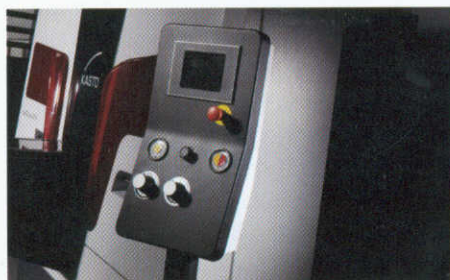
Überarbeitetes Bedienelement, in dem Hydraulik und Elektrik untergebracht sind.
