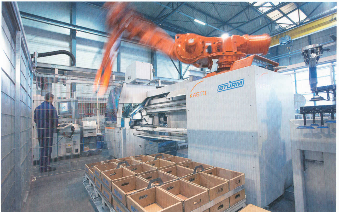
Vollautomatisierung in Perfektion: Der Kuka-Roboter legt die fertig gesägten Werkstücke in bereitgestellte Behälter ab, auch über Nacht und ohne Personaleinsatz. (Bilder: Stürm AG/Feurstein)
