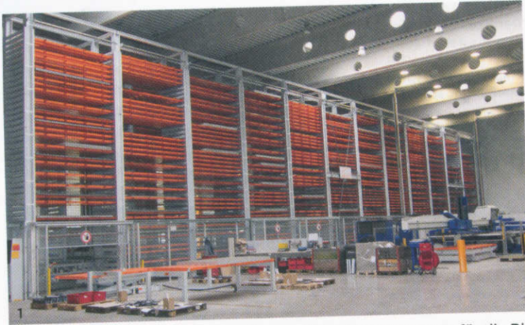
1 Blechlager mit Maschinenanbindung 2 Manipulationsgerät für die Blechbearbeitungsmaschinen-Beschickung, integriert ins Uniline-Lagersystem
