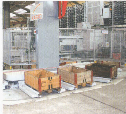
Bild 4: Paletten-Bahnhof zur auftragsgesteuerten Abschnittsortierung per Roboter
