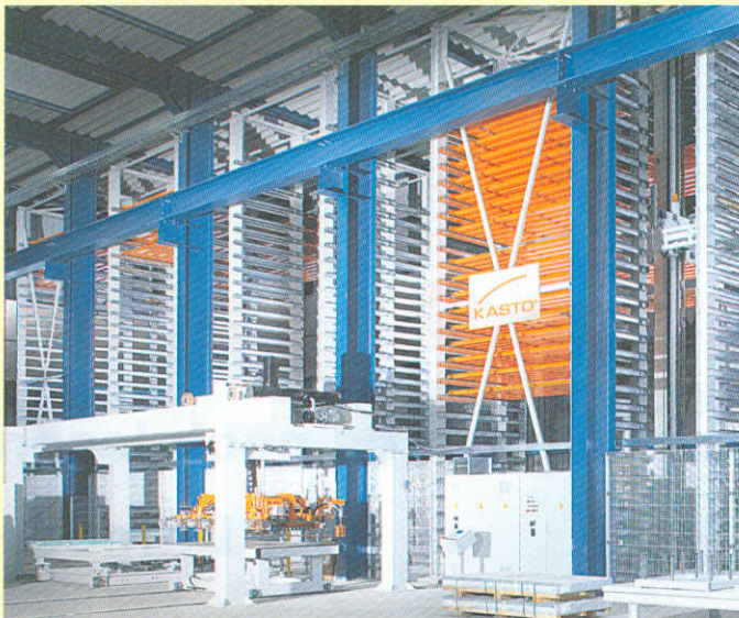
Uniline mit Auslagerstation und automatischem Kommissioniergerät.
