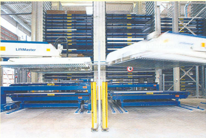
Uniline mit Be- und Entladestationen zur automatischen Anbindung von zwei Laserschneidmaschinen.
