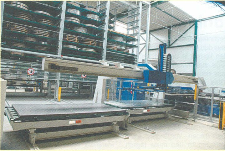
Uniline mit Be- und Entladestation zur automatischen Anbindung einer Stanzmaschine.
