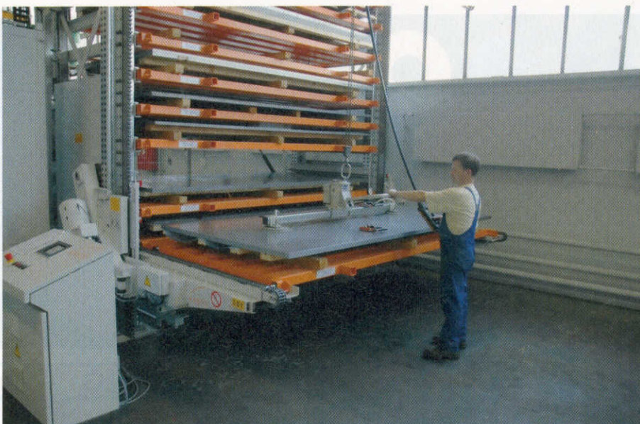
Materialentnahme aus dem Lagersystem vom Typ Unitower C mit manueller Handlungseinrichtung.
