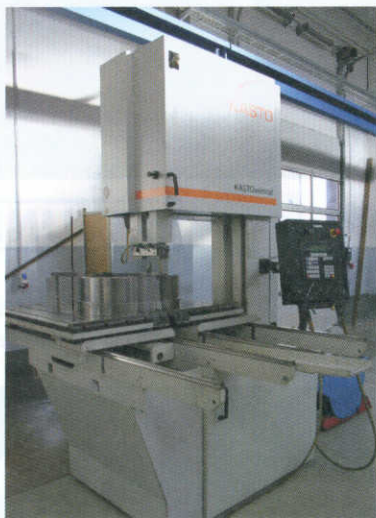
Die Bandsägemaschine Kastovertical beim Trennen eines massiven, fertiggedrehten Rings durch Präzisionssägen mit Genauigkeiten von 0,1 mm. (Bilder: Kasto)
