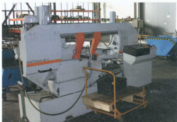
Hochleistungs-Bandsägemaschine Kastotwin AE4 zur reproduzierbar massgenauen Rohteileherstellung.
