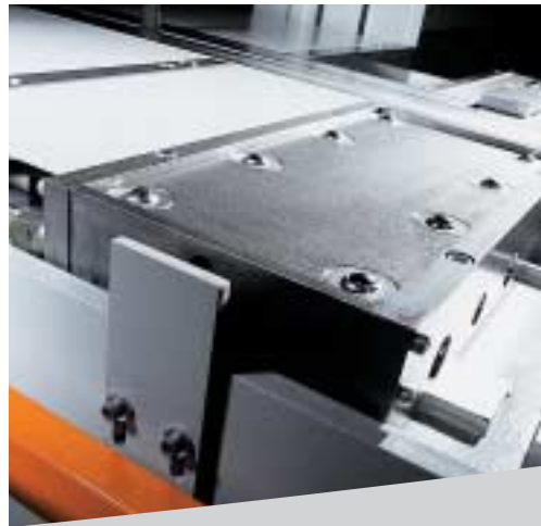
La manipulation des blocs et des tôles lourdes est un jeu d'enfant grâce à des tables à billes relevables et abaissables.
