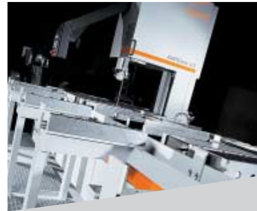
Elargissement de la table extérieure, pour débiter des tôles de grandes dimensions.
