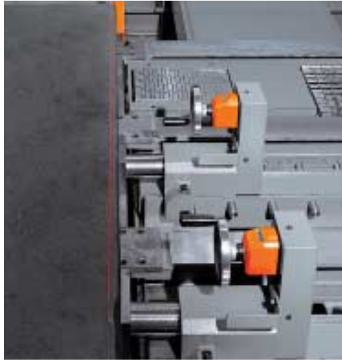
Butées de mesure mécaniques, avec réglage rapide et aisé.
