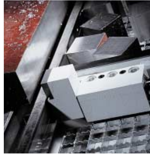
Butée escamotable hydraulique, pour le positionnement des tôles sur les références automatisées.
