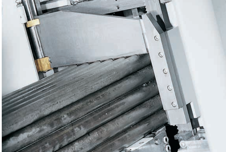
Hydraulisches Niederhalteschwert für stabile 4-Punkt-Spannung von Einzelstäben, Materiallagen und -bündeln (Option).
