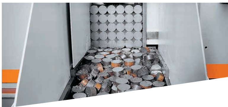
Motorisch angetriebener Rütteltisch mit Spüleinrichtung für weitgehend spannfreie Abschnitte (Option).
